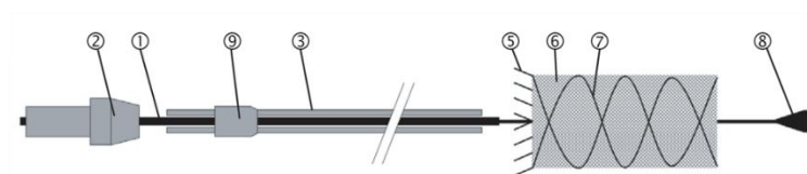
Kuva 5: A) p64 virtausta muuttava laite ja asetusjärjestelmä, B) irrotettu asetusjärjestelmä ja laajennettu p64-implantti.
